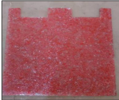
Rajah 3: Penutup kotak soket yang dihasilkan daripada bahan yang dikaji
