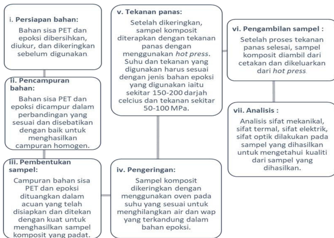
Rajah 1: Carta alir penghasilan sampel komposit sisa PET/epoksi.
